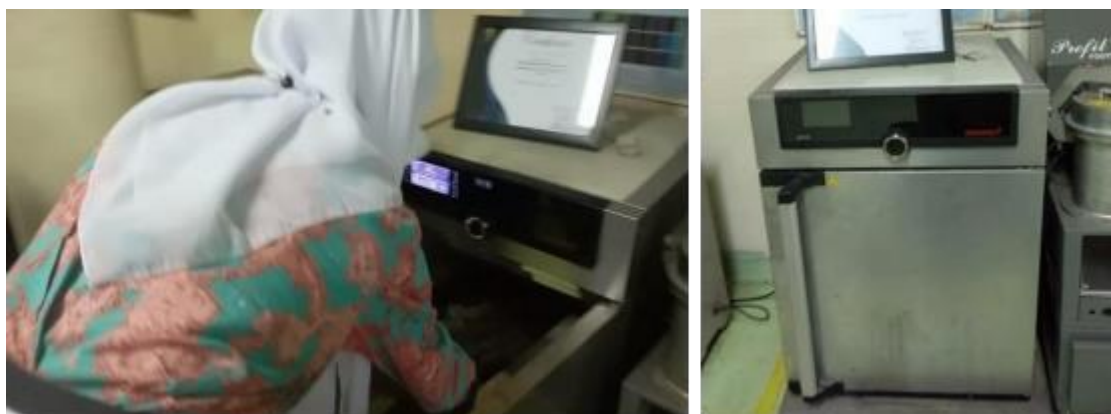
Gambar 5. Memasukkan Sampel Pada Oven Hingga Kering dan Mengeras
