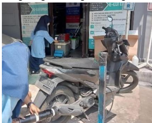
Gambar 11. Uji Emisi Motor Dengan Analyzer
