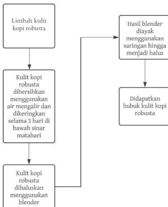
**Gambar 3.** Diagram Pembuatan Bubuk Kulit Kopi Robusta
